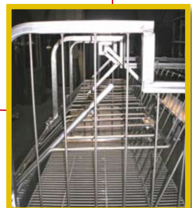
Modèle avec système d'avancement des canards par l'arrière et échancrage pour optimiser la ventilation par gaine
