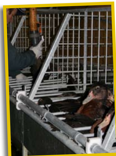
Contention à l'avant par rabattement du peigne et rapprochement des canards par avancement de la grille du fond
